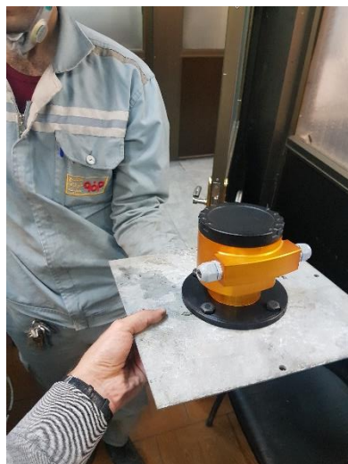
نصب سنسور سطح سنج مخازن RLM70 در مخازن گندله فولاد مبارکه اصفهان و فولاد خوزستان
