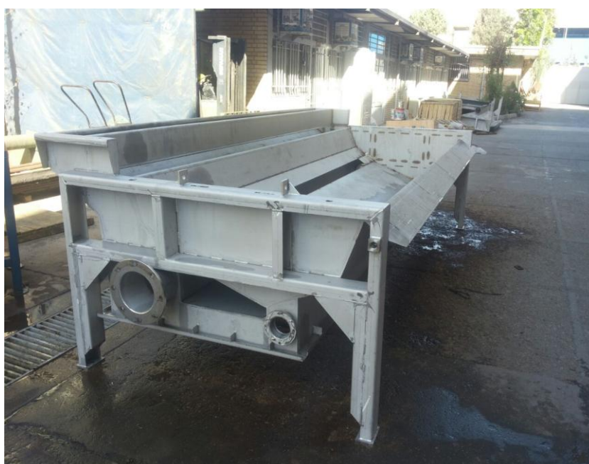
ساخت هوزینگ های استنلس استیل فولادسنگان
