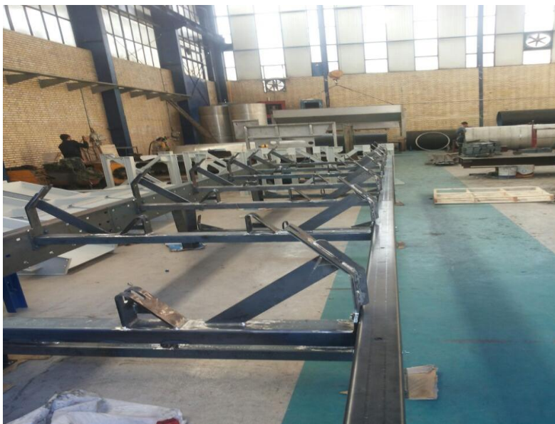
ساخت شاسی و پایه رولیک فولادسنگان
