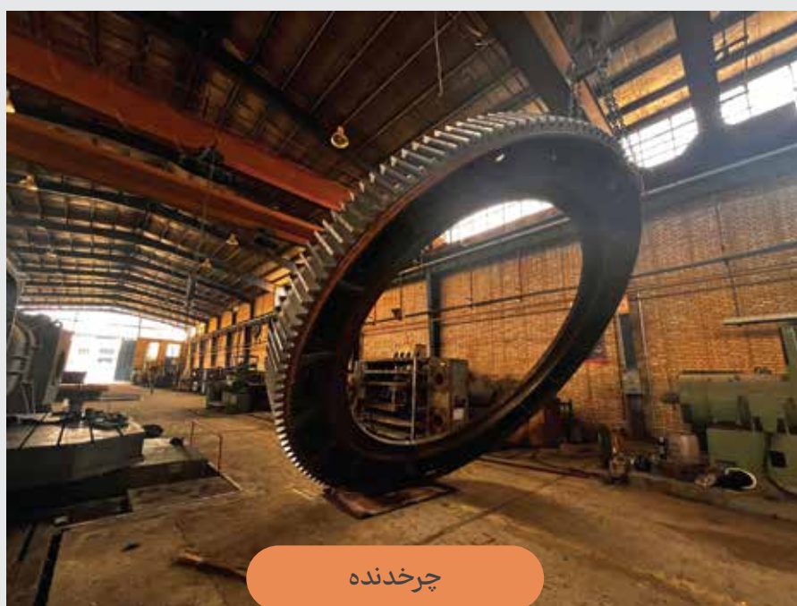
چرخنده به قطر ۴ متر و وزن ۱۸۰۰۰ کیلوگرم
