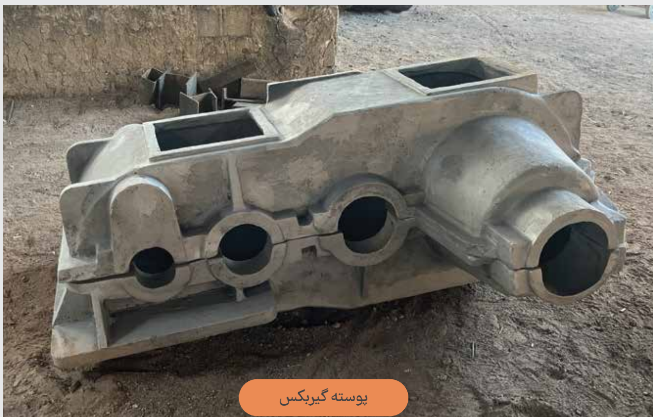
پوسته فولادی گیربکس به طول ۶ متر وزن ۸۰۰۰ کیلوگرم
