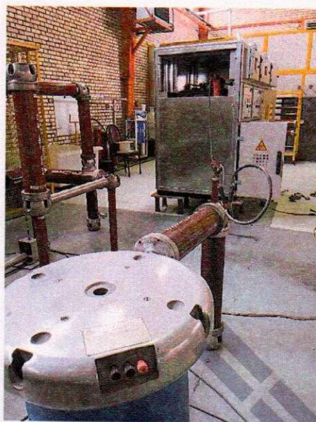
تصویر ۱: تجهیز تحت آزمون ولتاژ قابل تحمل فرکانس قدرت
