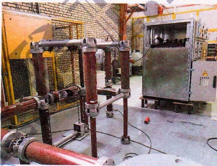
تصویر ۲: تجهیز تحت آزمون ولتاژ قابل تحمل ضربه
