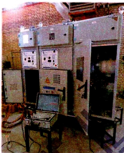
تصویر ۴: آزمون اندازه گیری مقاومت مدار اصلی
