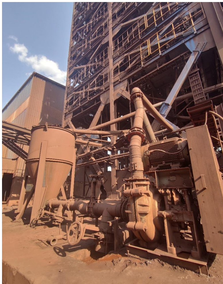
شکل ۱- پمپ اسلاری مدل SL-E-8-6 سرویس کاری: تغذیه اسپیرال محل نصب: کارخانه فراوری سنگ آهن تنگ زاغ بندرعباس
