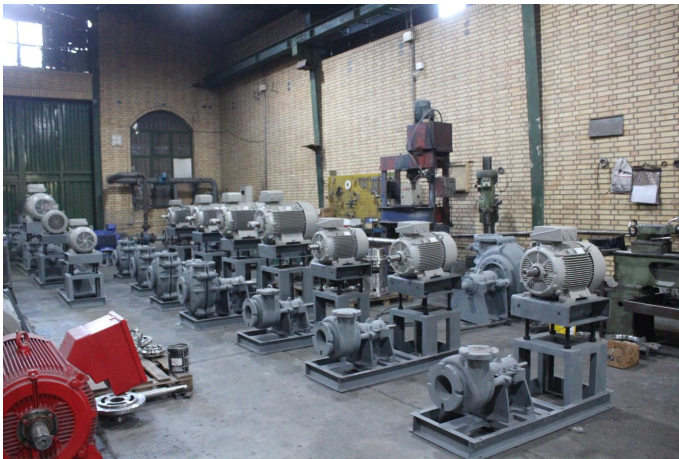
شکل ۳- پمپ های اسلاری ساخته شده پروژه کنستانتره آهن شرکت سپهر صنعت آرتا در محل کارخانه بهریز پمپ سامان
