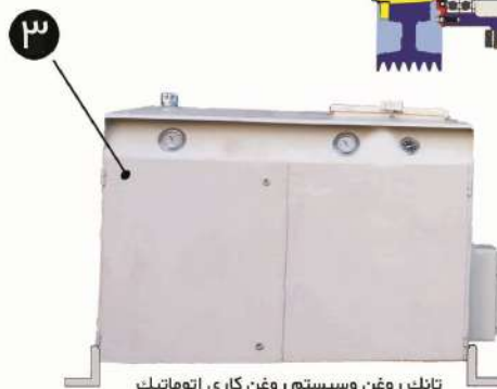
تانک روغن و سیستم روغن کاری اتوماتیک
