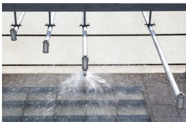
آزمایش توزیع آب بر حسب مساحت پوشش مطابق با استاندارد UL199
